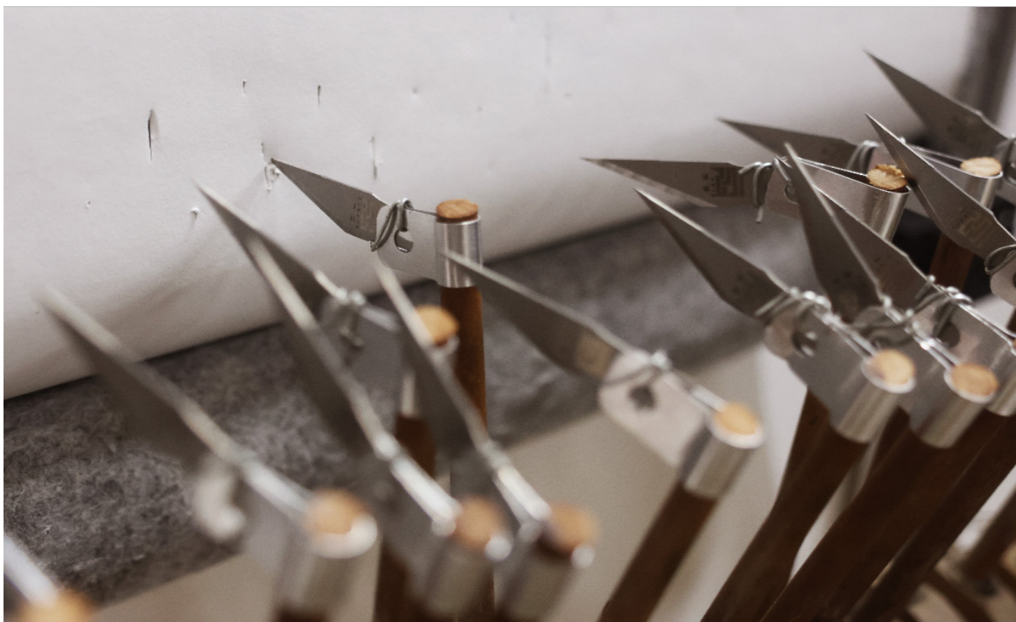
刀片刺向滚筒带动的纸带, 纸带持续循环滚动, 刀片在纸带上留下痕迹
